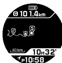
La modalità Backtrack mostra l'itinerario e la direzione per il ritorno al punto di partenza
