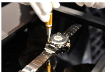
Montagem da parte traseira do relógio especial
